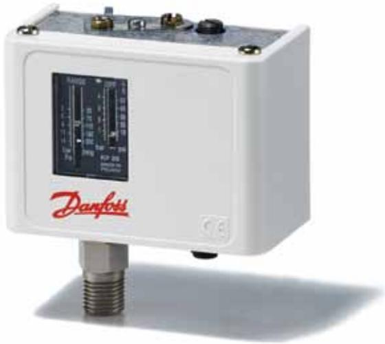
I pressostati Danfoss KP si utilizzano nei sistemi di controllo, di monitoraggio e di allarme in applicazioni industriali. La serie KP è adatta a mezzi gassosi ed aria. Questi pressostati sono muniti di un commutatore monopolare (SPDT) e possono controllare direttamente motori a corrente alternata monofase fino a 2 kW.
