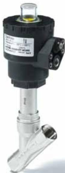
AV210 è una valvola ad azionamento pneumatico con sede inclinata per applicazioni industriali severe. La valvola può funzionare a temperature del fluido e viscosità molto alte, e non è sensibile alle particelle di sporco nel fluido; per questo motivo è spesso indicata come valvola “senza problemi”.
