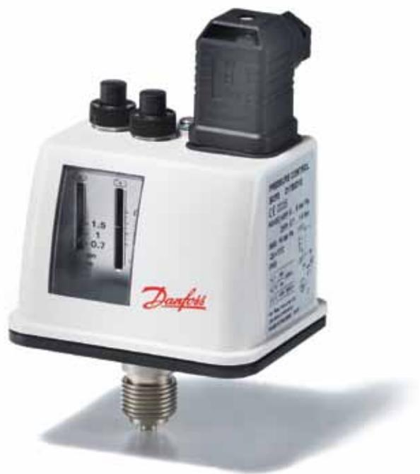
Il tipo BCP è una serie di pressostati per applicazioni di sicurezza e monitoraggio della pressione nelle caldaie a vapore e ad acqua surriscaldata. Il BCP incorpora un microinterruttore a commutazione unipolare in cui la posizione del contatto dipende dalla pressione nell'attacco e dal valore del campo impostato. Per applicazioni in cui il funzionamento è un elemento critico per la sicurezza, si consiglia l'utilizzo di un pressostato intrinsecamente sicuro.
