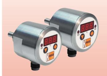
Messbereich: -20...+120°C t<sub>max</sub> 125°C; p<sub>max</sub> 80 bar Anschluss: G ½, G ¾, ½" NPT, ¾" NPT AG 2 Grenzkontakte Genauigkeit: ±0,5°C
