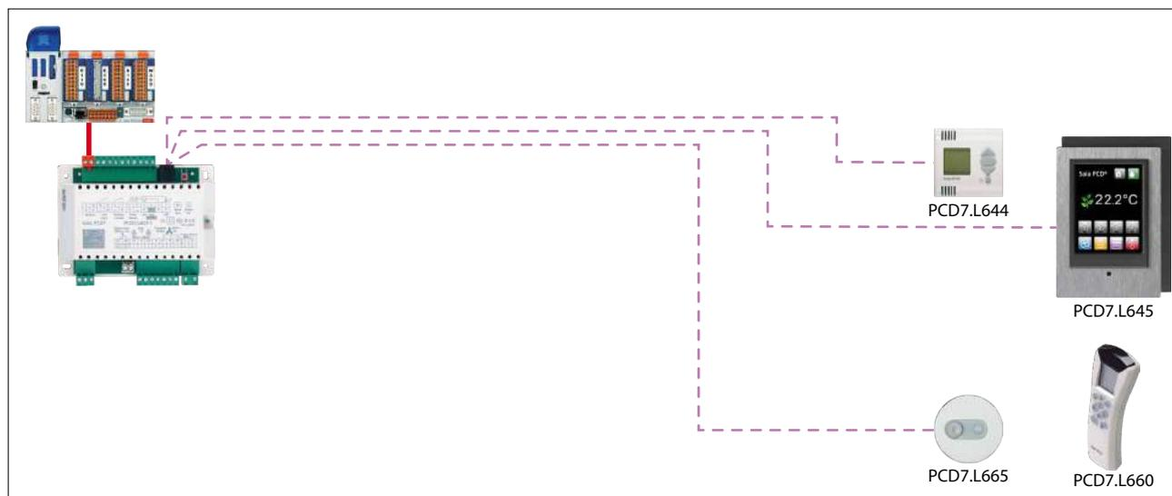
Il sistema di regolazione di camera combinabile PCD7.L6xx, basato sulle reti S-Net seriale o LonWORKS®, è utilizzabile in modo predominante in applicazioni HVAC con dispositivi fan-coil, combinazioni di radiatori/raffrescamento a soffitto o sistemi a regolazione variabile del flusso (VVS). Grazie alla vasta gamma di unità di comando di camera, è possibile creare diverse soluzioni operative.
