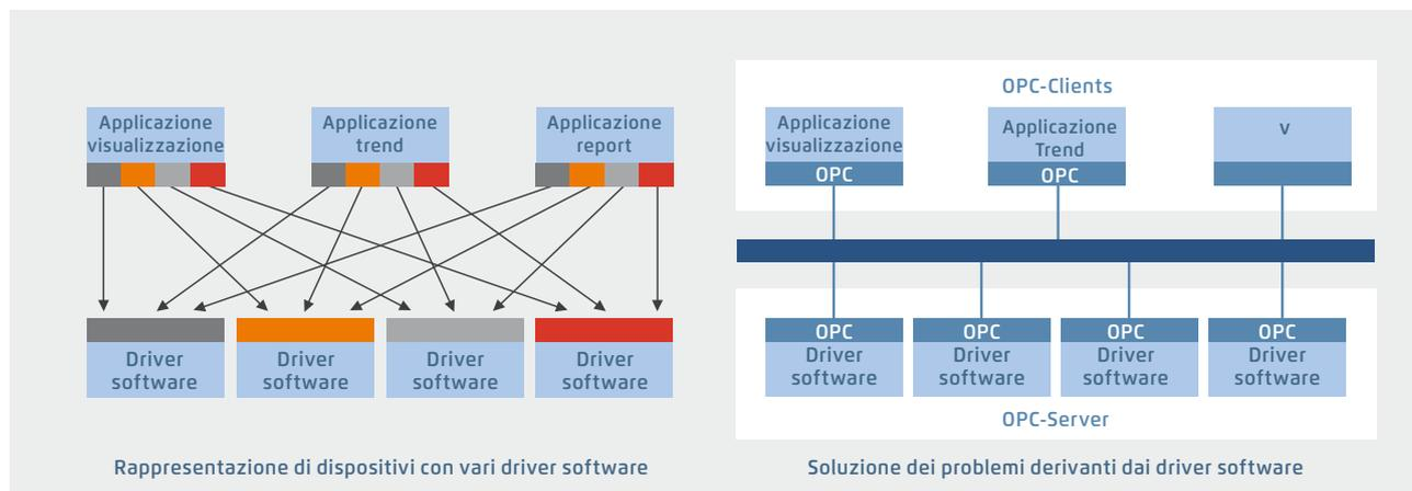
Con l'interfaccia standard OPC, non è più necessaria l'esperienza in protocolli specifici del produttore. Ciò consente la significativa riduzione dell'onere di sviluppo, messa in servizio e manutenzione.
