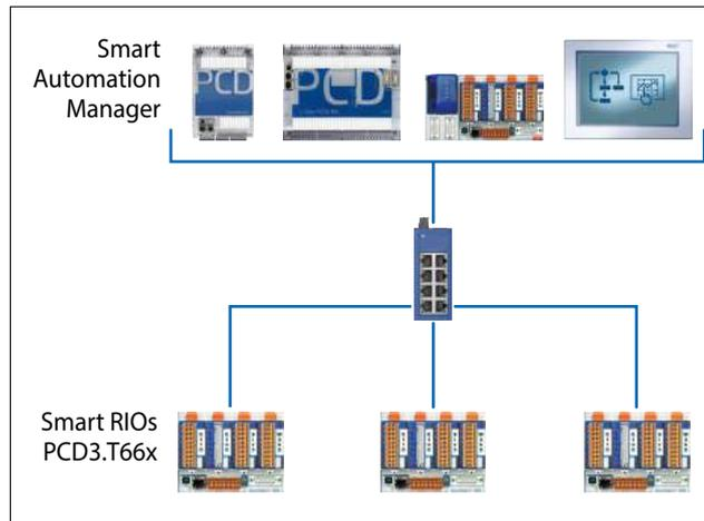
Le CPU PCD1.M21x0, PCD2.M5, PCD3.M2/3/5 nonché i pannelli Micro-Browser programmabili PCD7.D4xxxT5F si possono utilizzare come Smart Automation Manager
