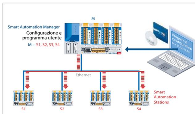
I programmi applicativi sono gestiti centralmente dallo Smart Automation Manager e distribuiti agli Smart RIO. Nel caso si dovesse sostituire l'hardware, i programmi e la configurazione vengono automaticamente ricaricati. Per memorizzare i programmi RIO, il Manager dispone di sufficienti risorse di memoria. A tale proposito, è possibile utilizzare la memoria di programma integrata e i moduli di memoria flash innestabili PCD3.Rxxx e PCD7.Rxxx.
