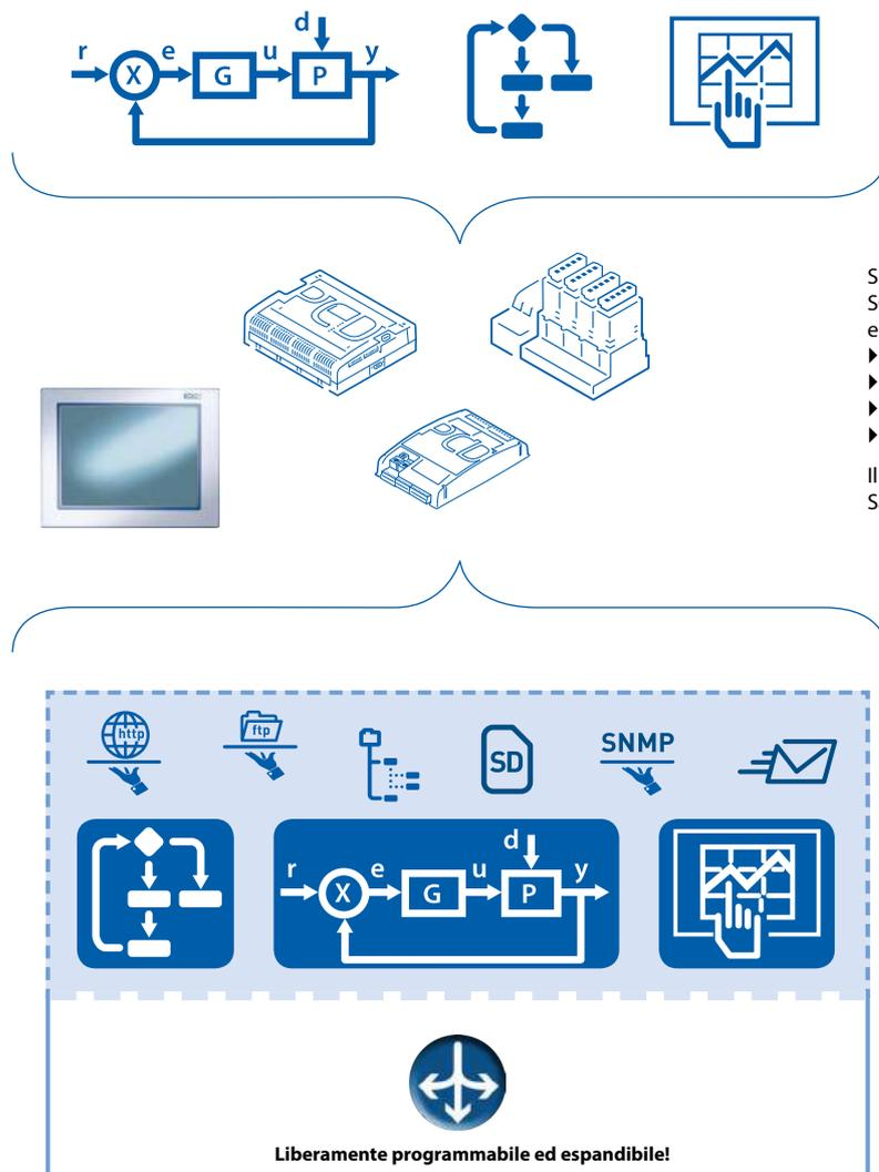
▲ **Schema funzionale delle unità di controllo Saia PCD®:** L'intera applicazione di automazione è integrata. La combinazione di funzioni Web+IT non proprietarie e globalmente standardizzate, conosciute come Automation Server, fornisce l'interfaccia per l'ambiente. La libera programmabilità e l'espandibilità modulare dei controllori assicurano il «perfetto adattamento» alle attività correnti per un ciclo di vita di 15-20 anni, senza la necessità di nuovi investimenti.
