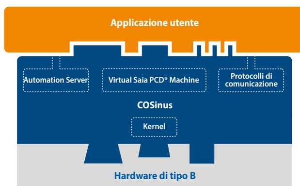
▲ Il sistema operativo COSinus mette a disposizione dell'applicazione sempre la stessa infrastruttura, indipendentemente dal tipo di hardware e processore sottostanti. La chiave di tutto questo è la Virtual Saia Machine. Garantisce che un programma applicativo creato con PG5 funzioni su tutti i PCD per generazioni.
