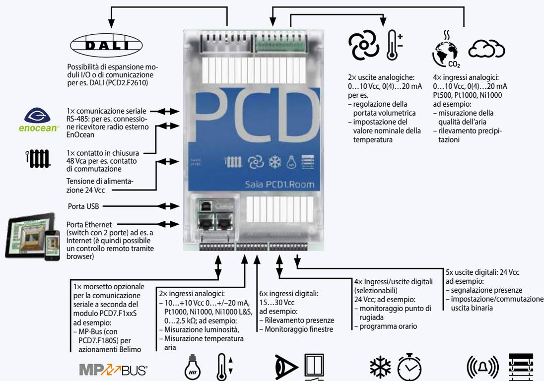
Con questo controllore, illuminazione, schermatura solare e regolazione individuale di camera possono essere adattate tra loro in modo ottimale. L'esempio mostra una possibile installazione, basandosi su applicazioni secondo la lista di funzioni dell'automazione di camera VDI 3813 e la lista di funzioni di Building Automation ai sensi della norma DIN EN 15232.
