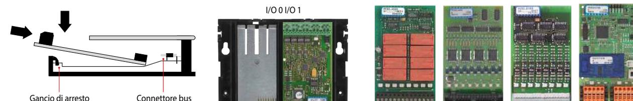
**!** Sullo slot I/O 1 funziona solo un modulo PCD2.W525, già incluso nella fornitura. Se il modulo viene estratto, il controllore si arresta!
