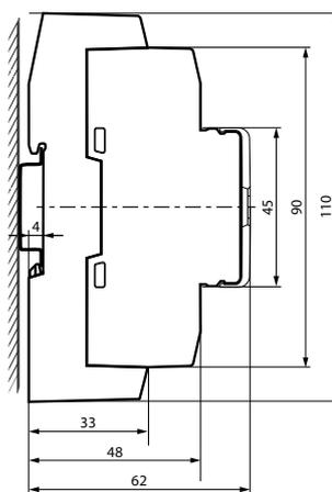
Montaggio su guida DIN 35 mm
