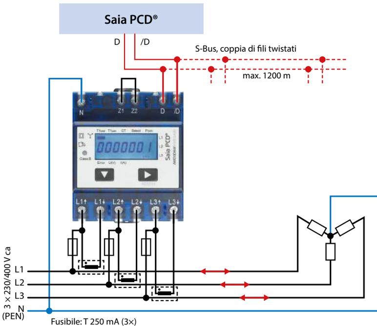
▲ Misurazione dell'energia in entrambe le direzioni di flusso usando un Saia PCD® per l'ulteriore elaborazione dei valori misurati
