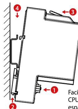
Facilità di montaggio delle CPU e dei contenitori di espansione sulla guida DIN (1 x 35 mm)
