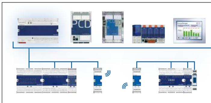
Come accoppiatori di rete possono essere utilizzati, oltre ai controllori PCD1.M0/PCD1.M2 anche CPU PCD2.M5, PCD3.M3/5/6 e Micro Browser Panel PCD7.D4xxxT5F programmabili.
