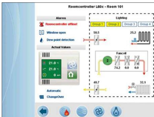
Visualizzazione e gestione dei parametri di camera tramite Web Server
