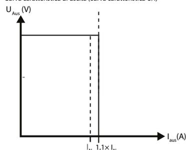
La protezione contro il sovraccarico di corrente limita quest'ultima a un valore costante di  $1,1 \times$  di corrente nominale
