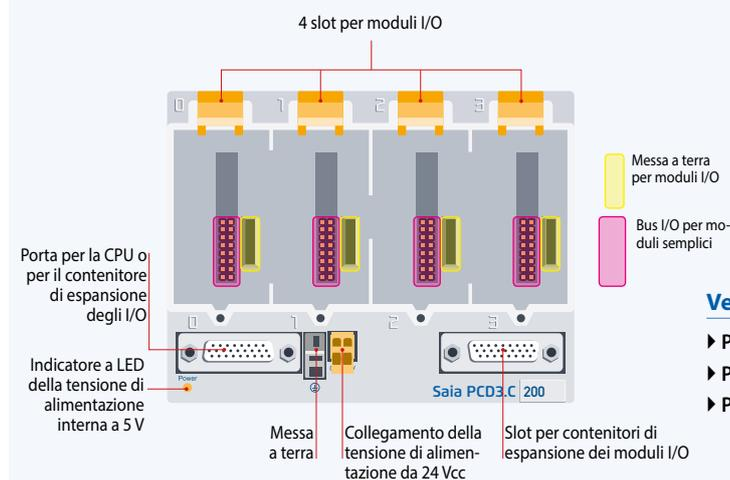
Nel supporto per moduli di espansione è possibile utilizzare tutti i moduli I/O standard. Moduli di comunicazione o altri moduli intelligenti si possono utilizzare solo negli slot di base della CPU.
