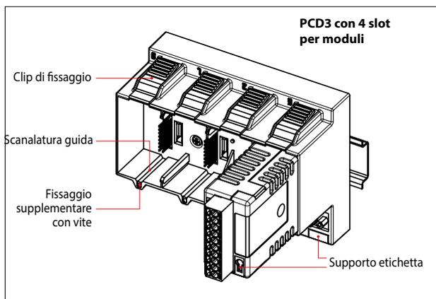
▲ Semplice sostituzione dei moduli di I/O
