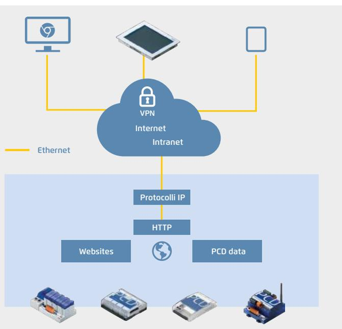
Hypertext Transfer Protocol (HTTP) è un protocollo utilizzato per il trasferimento dati attraverso una rete. Con i Saia PCD®, il protocollo viene utilizzato per l'accesso al web server dei PCD.
