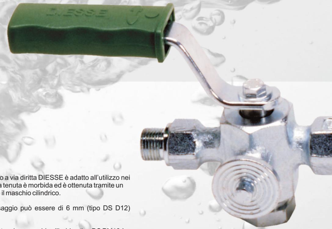
Il rubinetto a maschio cilindrico a via diritta DIESSE è adatto all'utilizzo nei più svariati settori di attività. La tenuta è morbida ed è ottenuta tramite un bossolo installato tra il corpo e il maschio cilindrico.
