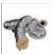
Canale flessibile con isolamento termo acustico. Condotta interna in alluminio perforato, isolamento in lana di vetro, rivestimento esterno in pellicola d'alluminio rinforzata da fibra di vetro
