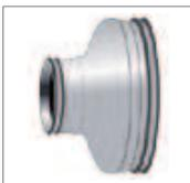
Riduzione circolare Ø 80 - Ø 63 mm. Stampata in acciaio zincato, con guarnizioni di tenuta gomma.
