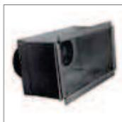
Plenum in lamiera di acciaio zincata per mandata e ripresa dell'aria per installazioni a controsoffitto. Configurazione in line. Progettato per montaggio di griglie 300x100 mm, 3 attacchi Ø 63 mm e 200x100 mm, 2 attacchi Ø 63 mm. Cornice telescopica in dotazione per facilitare l'installazione. Attacchi con guarnizioni.
