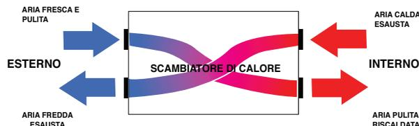
Nella sua configurazione tipo il recuperatore energetico non è un generatore di calore né un refrigeratore d'aria, pertanto deve essere utilizzato ad integrazione di un impianto di riscaldamento e/o climatizzazione.
